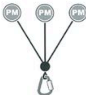
Stanowisko ratownicze na bezwzględnie pewnym punkcie mocowania (BPPM)
