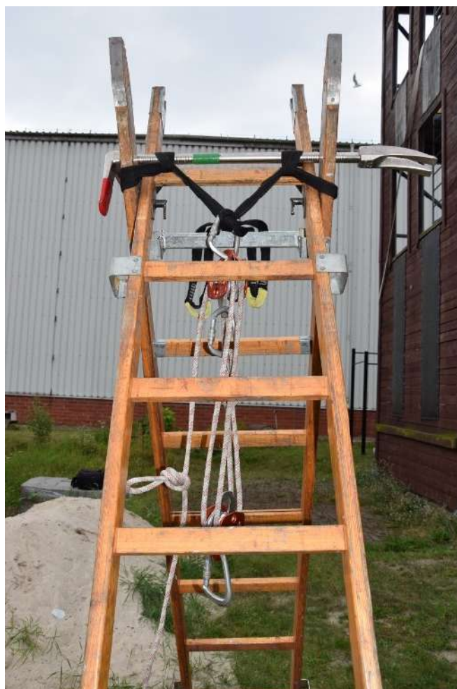
Rys. 58). Trójnoż ratowniczy „zastępczy” w układzie 1 : 4
