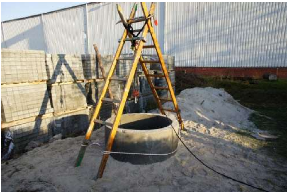
Rys. 13). Trójnóg ratowniczy z drabin DN 2,4
