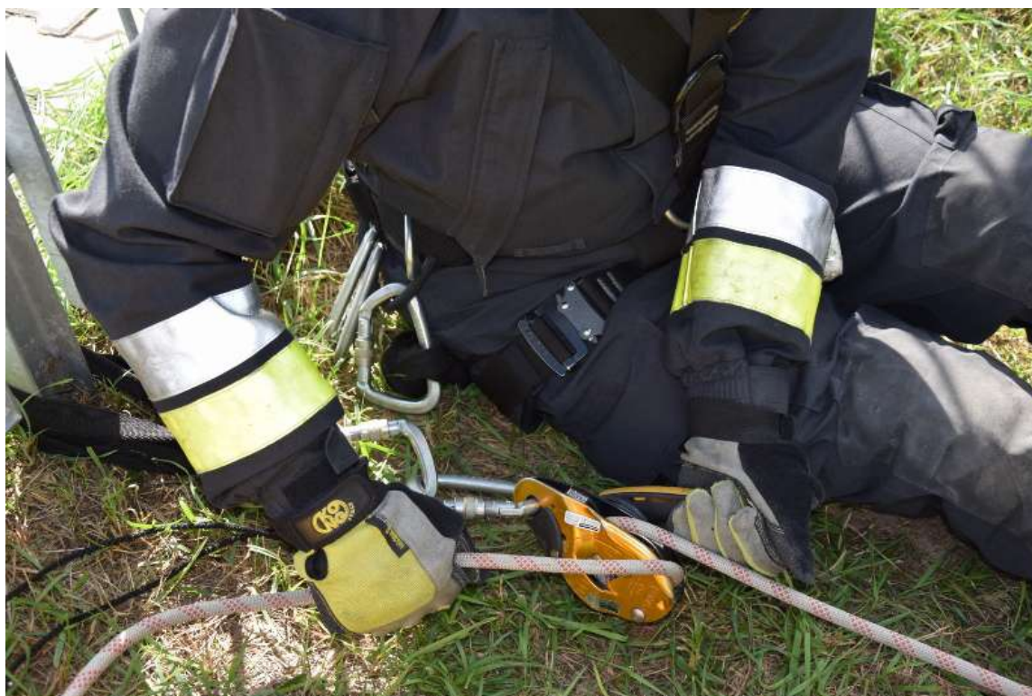
Rys. 36). Poruszanie się po powierzchni pochyłej z asekuracją ze stanowiska górnego przez I'D i półwyblinkę
